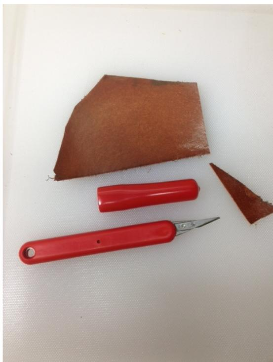
Cutter professionale per pelletteria modello Mozart, il classico 'coltellino rosso'. Lama di lunga durata per un taglio sempre eccellente e preciso. Manico in gomma e lama sostituibile tramite le due piccole viti.
